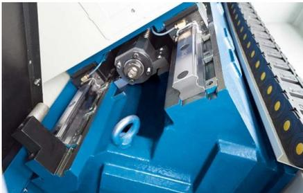
*Станина с наклоном 45° и линейными направляющими*
