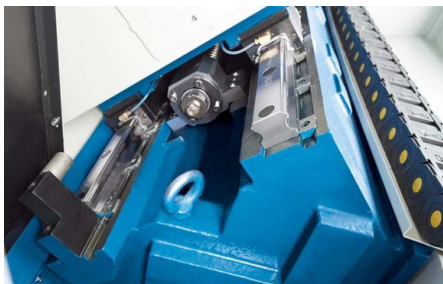
Banc incliné à 45° avec guidages linéaires
