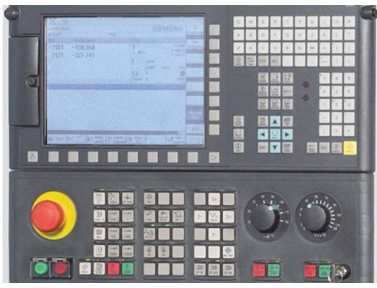
Siemens Sinumerik 828 D: la solución compacta y fácil de usar para los tornos
