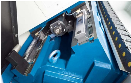
Cama inclinada a 45° con guías lineales
