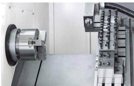
Линейный магазин смены инструмента с одним приводным инструментом
