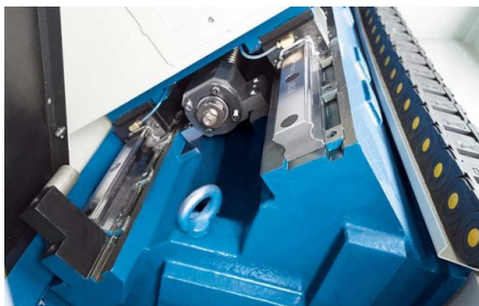
Станина с наклоном 45° и линейными направляющими
