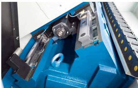
Станина с наклоном 45° и линейными направляющими
