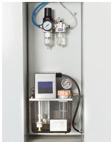
Dispositif de lubrification centralisée et unité de maintenance
