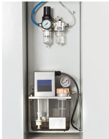
Sistema de lubricación central y unidad de mantenimiento
