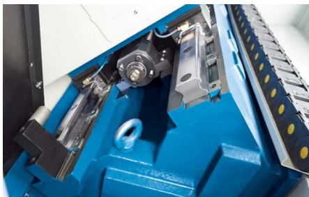
Cama inclinada a 45° con guías lineales
