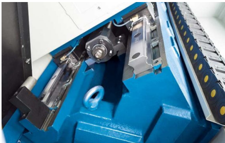
Cama inclinada a 45° con guías lineales
