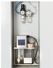
Zařízení centrálního mazání a údržbová jednotka
