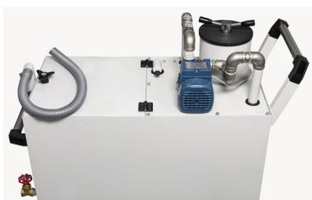
*Serbatoio dielettrico con sistema di filtraggio doppio*
