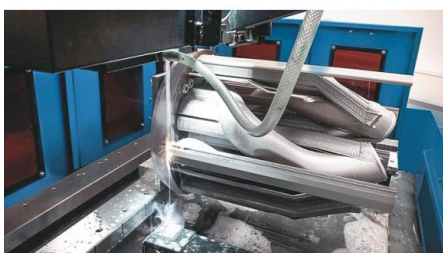
La production additive génère des composants complexes sur une plaque de métal qui doit ensuite être séparée des composants (Neospark 500 B Continental Engineering Services).
