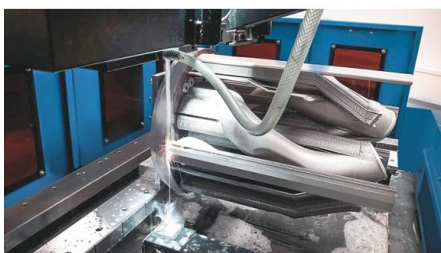
W przypadku produkcji addytywnej powstają złożone części na metalowej płytce, którą następnie trzeba oddzielić od części (Neospark 500 B Continental Engineering Services)
