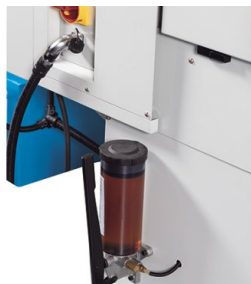
La lubrification centrale facilite l'entretien
