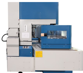
Le système d'électro-érosion à fil se caractérise par une excellente accessibilité et est parfaitement protégé par des couvercles robustes
