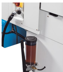
El sistema de lubricación central simplifica el mantenimiento
