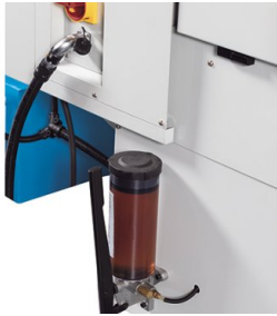
Zentralschmierung erleichtert Wartung
