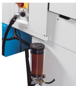
La lubrification centrale facilite l'entretien
