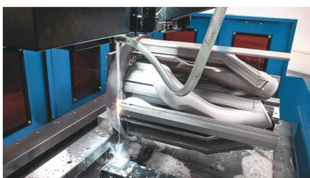
En la producción aditiva (impresión 3D), las piezas complejas producidas están unidas a una placa de metal, y después, la placa de metal tendrá que separarse del componente (Neospark 500 B Continental Engineering Services)
