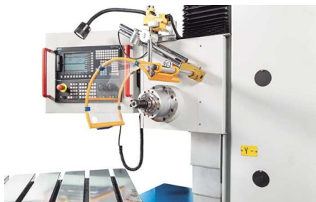
Couvercle de broche de fraisage avec interrupteur de sécurité
