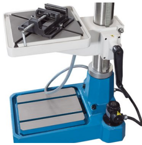
Motor pentru avans cu reglare fără trepte
