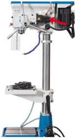
Motor pentru avans cu reglare fără trepte
