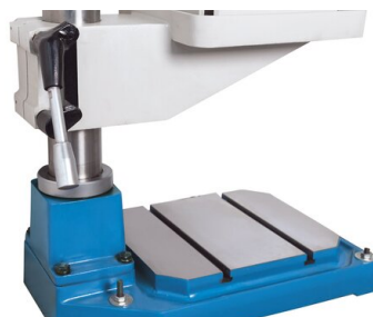
Placă de bază mare cu caneluri de prindere paralele, pentru piese de prelucrat mari
