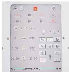
*Touchscreen ad alta risoluzione con superficie resistente alle rotture. La velocità di lavorazione e quella d'avanzamento adatte al tipo di foratura da effettuare, possono essere richiamate da una banca dati e rilevate automaticamente*
