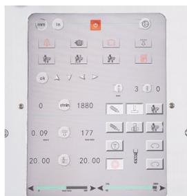
*Hochauflösender Touchscreen mit kratzfester Oberfläche. Zum Bohrer passende Drehzahlen und Vorschubgeschwindigkeiten können einer Datenbank abgerufen und automatisch übernommen werden.*
