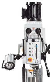
TSB 25: компактное исполнение с коробкой передач
