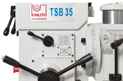
Tête de perçage pivotante et avance auto avec 3 gammes de vitesse
