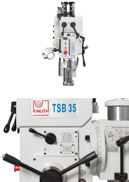
Tête de perçage pivotante et avance auto avec 3 gammes de vitesse
