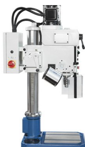
TSB 25 : version compacte avec boîte de vitesses
