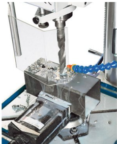
Circuito di raffreddamento incluso nella dotazione standard
