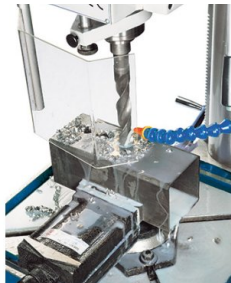
Устройство для подачи смазочно-охлаждающей жидкости в стандартной комплектации
