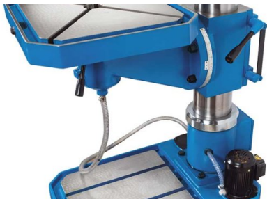
Masa pentru găurit, cu dimensiuni mari, poate fi reglată unghiular
