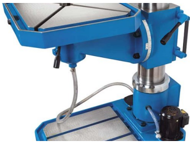
L'angle de la table de perçage de grandes dimensions est réglable
