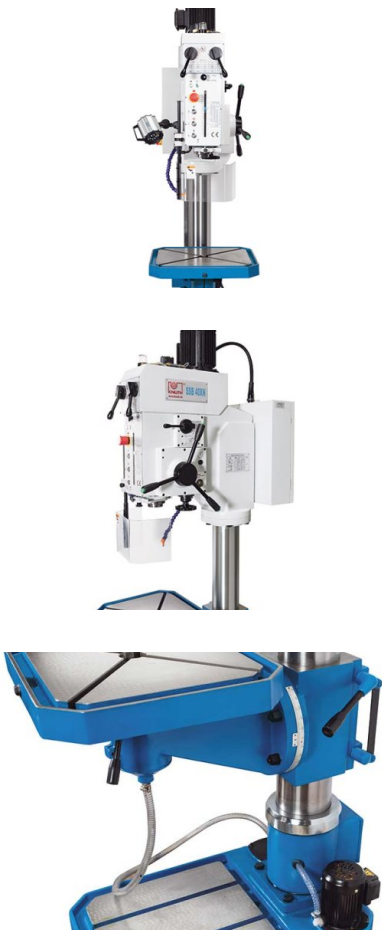
Der groß dimensionierte Bohrtisch ist winkelverstellbar
