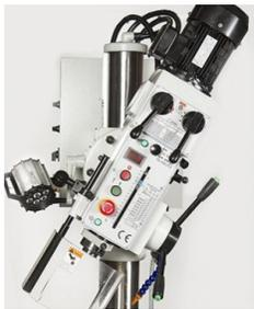
*Возможность поворота головки на  $\pm 45^\circ$  и регулировка по высоте*
