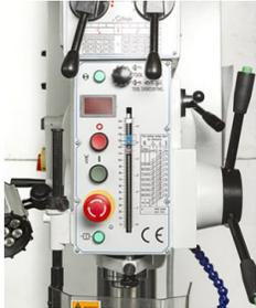
*Регулировка скорости при помощи механической коробки передач и изменение направления вращения шпинделя при помощи концевого выключателя на упоре ограничения*
