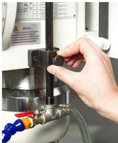
*Головка сверлильного станка регулируется по высоте.*
