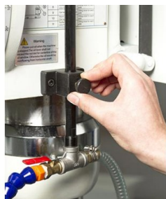
La tête de la perceuse est réglable en hauteur.
