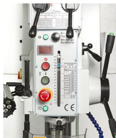
Réglage de la vitesse par boîte de vitesses et inversion du sens de rotation de la broche par interrupteur de fin de course sur la butée de profondeur
