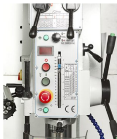
Ajuste de las rpm mediante transmisión manual, e inversión de la rotación del husillo mediante un interruptor de límite en la parada de profundidad
