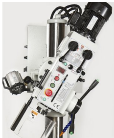
Hlava výkyvná a výškově přestavitelná o \pm 45^\circ
