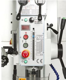
Přenastavení otáček pomocí manuální převodovky a otočení směru otáčení vřetene pomocí koncového spínače na hloubkovém dorazu
