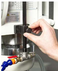
Hlava vrtačky je výškově přestavitelná.
