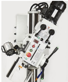
Kopf \pm 45^\circ schwenkbar und höhenverstellbar
