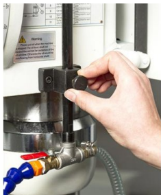
Der Kopf der Bohrmaschine ist in der Höhe verstellbar.
