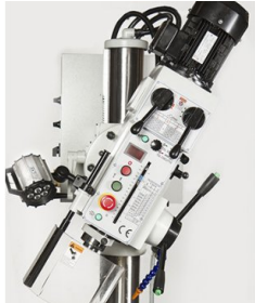
Głowica wychylna o \pm 45^\circ z regulowaną wysokością
