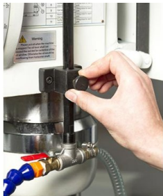
Głowica wiertarki ma regulowaną wysokość.
