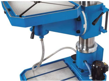
Большой сверлильный стол имеет регулировку угла наклона
