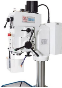
Transmisia cu 3 trepte a avansului, integrată în capul de găurire, funcționează cu întreținere minimă în baie de ulei și este cuplabilă cu ușurință
