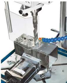
Se incluye el sistema de enfriamiento
