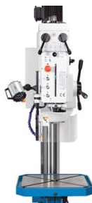
Vrtací hlava modelu SSB 32 Xn je otočná o \pm 45^\circ doleva a doprava a lze ji výškově nastavit
