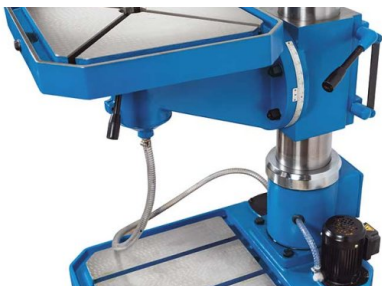
Большой сверлильный стол имеет регулировку угла наклона
