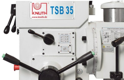
Cabezal del taladro giratorio y alimentación automática con 3 pasos de engranaje
