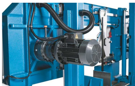
Výkonný motor hlavního pohonu, plynule regulovatelný
