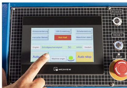
В автоматическом режиме можно программировать длину подачи, угол резки и количество резов в соответствующей конфигурации
