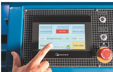
В автоматическом режиме можно программировать длину подачи, угол резки и количество резов в соответствующей конфигурации
