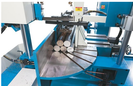
Instalație hidraulică tensionare fascicul pentru ambele menghine în serie
