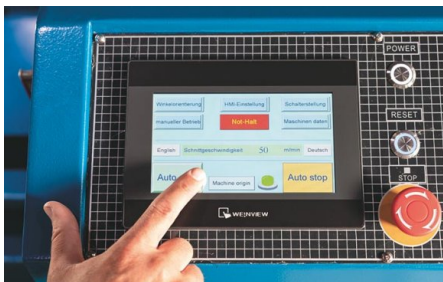
En modo automático, la distancia de alimentación, el ángulo de corte y la cantidad de cortes se pueden programar dentro de las configuraciones respectivas
