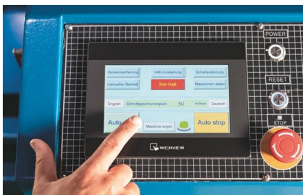
V automatickém režimu lze naprogramovat délku posuvu, úhel řezu a počet řezů v příslušné konfiguraci
