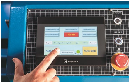
Im automatischen Modus können die Vorschublänge, der Schnittwinkel und die Anzahl der Schnitte in der jeweiligen Konfiguration programmiert werden
