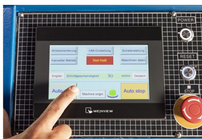
W trybie automatycznym możliwe jest programowanie długości posuwu, kąta cięcia oraz liczby cięć w poszczególnych konfiguracjach
