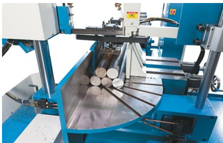
Hydrauliczne urządzenie do mocowania wiązki do obu imadeł, seryjne
