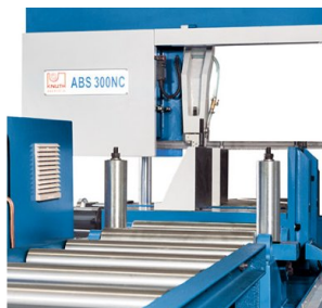
El transportador de rodillos estándar amplía el área integrada de soporte del material
