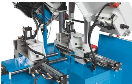
Dispositif de serrage de faisceaux pour la coupe en longueur de paquets de matériels
