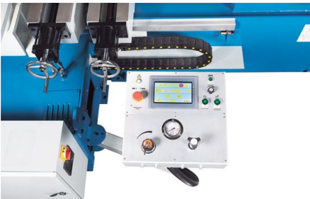
Ручная корректировка угла дуги пилы при помощи гидравлического привода (15°, 30° и 45°)
